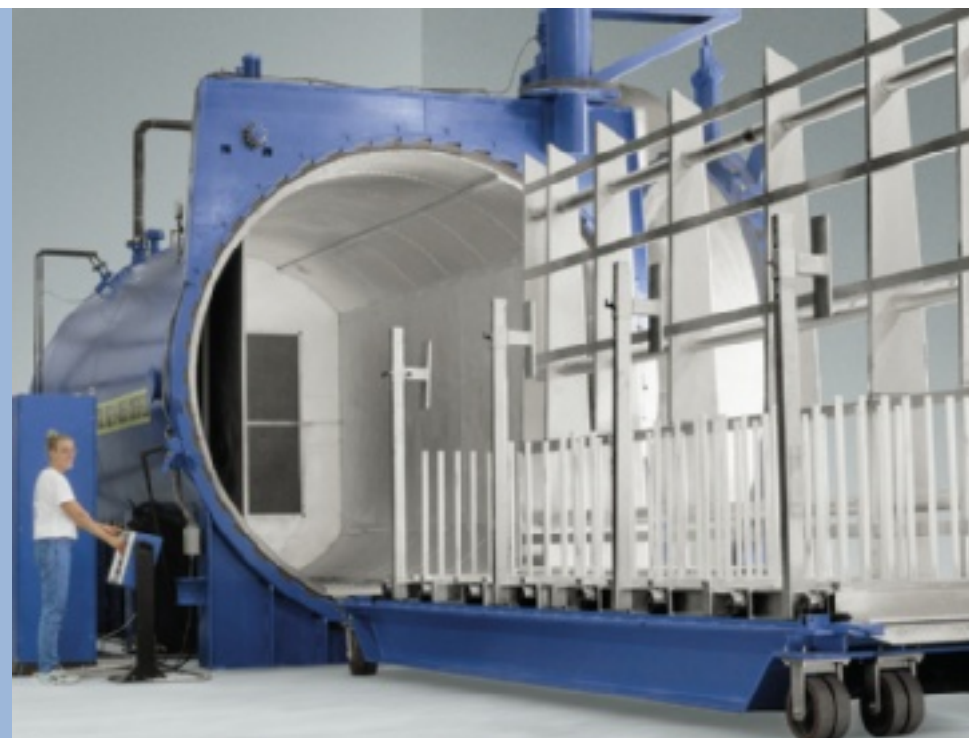
Autoklav zur Herstellung von Verbund-Sicherheitsglas Autoclave for the production of laminated glass
