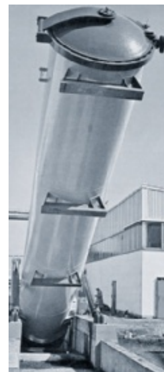
Edelstahlanlagen 1| Schnellverschluss ø 3700 mm für Anlagen zur Acetylierung Quick closing doors ø 3700 mm for acetylation systems (stainless steel) 2| Anlage ø 1600 x 8000 mm zum Färben von Holz System ø 1600 x 8000 mm for wood dyeing (stainless steel)
