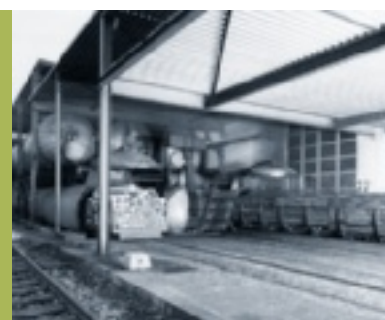
Teeröl-Imprägnieranlage für Masten und Schwellen Creosote impregnating plant for poles and sleepers
