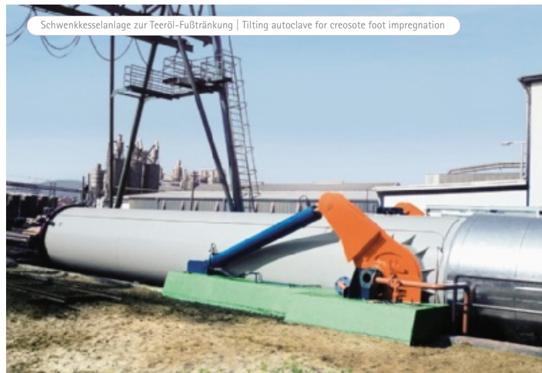
Teeröl-Imprägnieranlage für Masten und Schwellen Creosote impregnating plant for poles and sleepers
