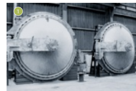
Edelstahlanlagen 1| Schnellverschluss ø 3700 mm für Anlagen zur Acetylierung Quick closing doors ø 3700 mm for acetylation systems (stainless steel) 2| Anlage ø 1600 x 8000 mm zum Färben von Holz System ø 1600 x 8000 mm for wood dyeing (stainless steel)
